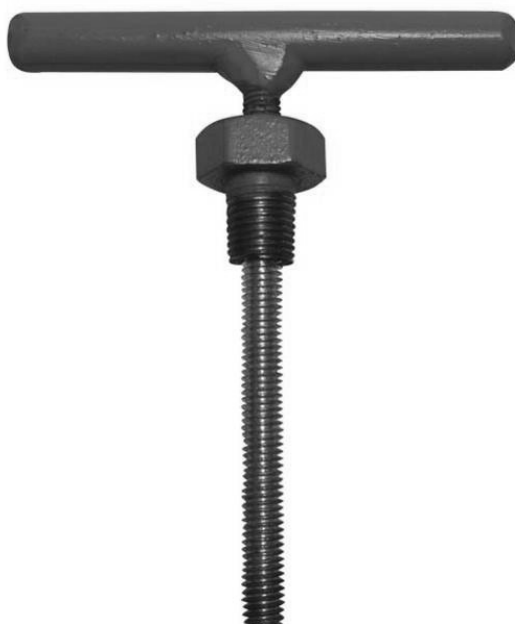
Рисунок 9.4 – Ключ для зарядки МГП КЗ-1
